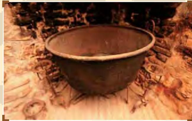
Si inizia a lavorare di solito di notte. La prima operazione è accendere il fuoco e mettere a bollire l'acqua nel caldaio di rame che sarà necessaria nel corso della lavorazione.
