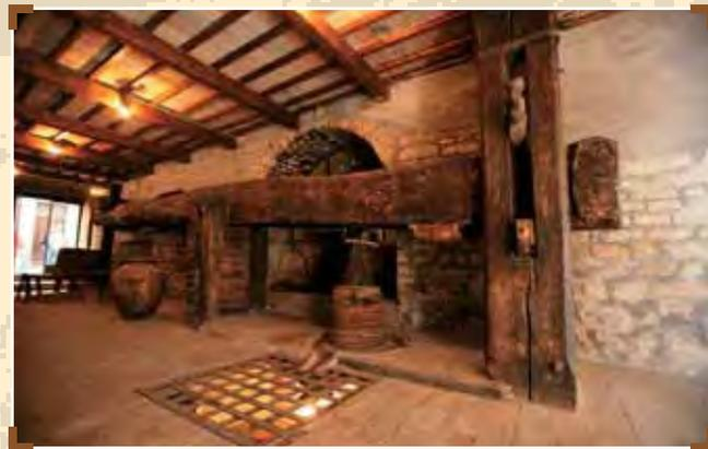
Finita l'operazione, si scaricano i friscoli nella macina facendola girare appena due giri con un po' di acqua calda, si ricaricano i friscoli e si rimonta la colonna, questa volta per la pressa gigante o della seconda pressione.
