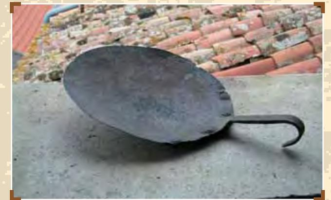
Si procede poi alla raccolta dell'olio con un grande cucchiaio di rame, molto aperto, del diametro di circa cm 20. L'operazione, cosiddetta di "sfiore", richiede molta abilità per separare il più possibile l'olio dall'acqua di vegetazione che viene eliminata attraverso la fognatura.
